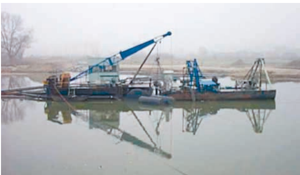
Extraction de sable par aspiration sous eau à partir d'une barge (Sablière Laurent à Tertre).
