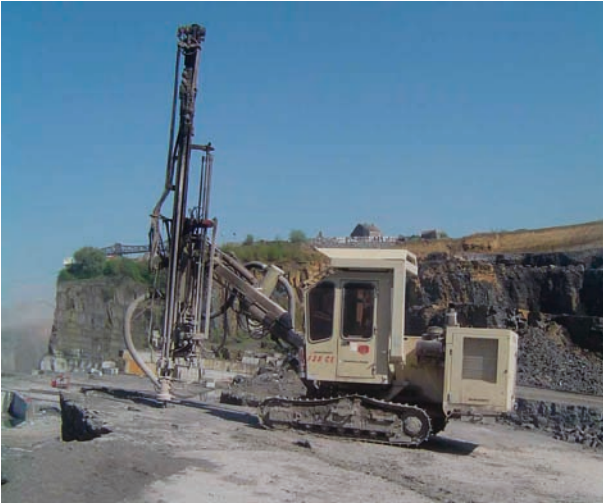
Engin de forage autonome avec compresseur embarqué et récupération des débris de roche remontés ou «cuttings».
