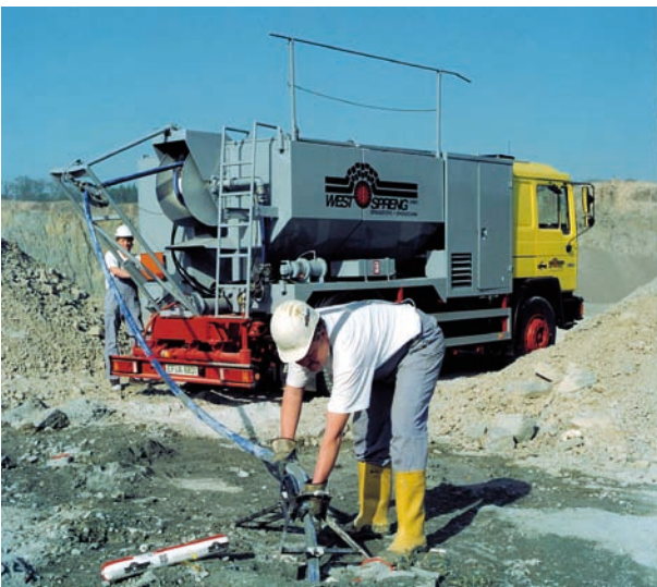
La séparation des composants en éléments inertes sécurise le transport ; la préparation du mélange qui devient explosif est faite juste au moment du chargement des fourneaux.
